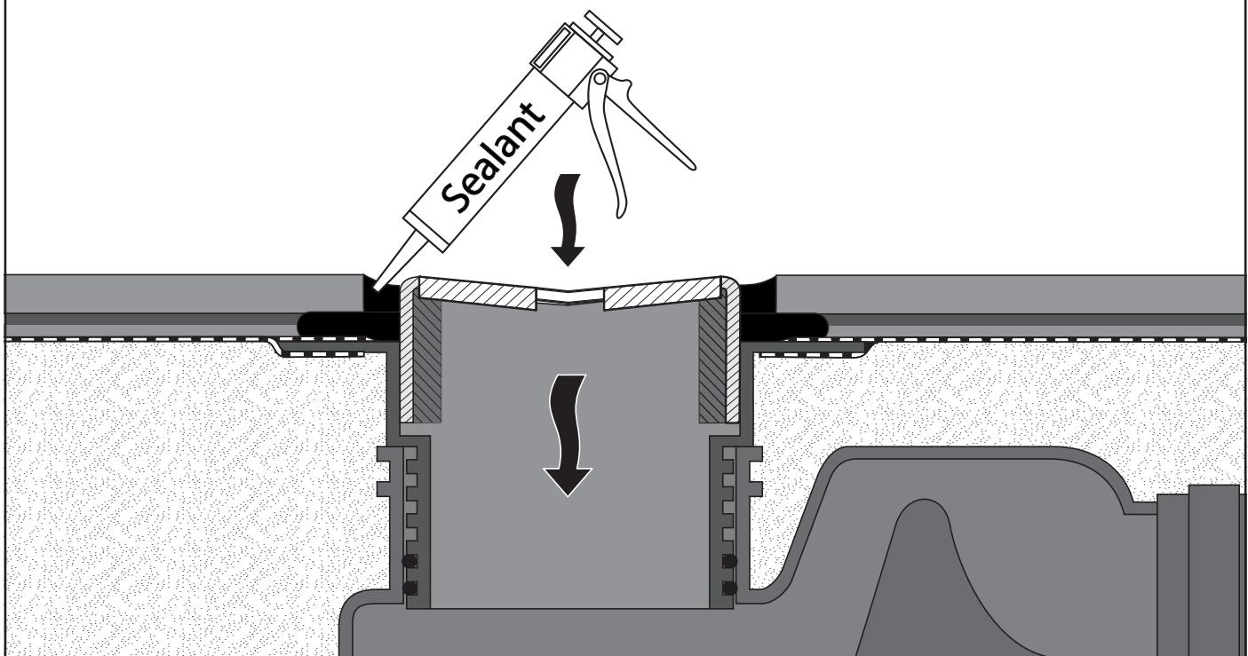
**B** Sekundär Entwässerung | Secondary drainage
