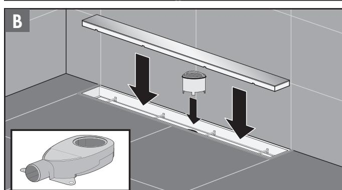
Siphon Reinigung / Siphon Cleaning / Nettoyage du siphon / Sifon čištění / Szifon tisztítása / Czyszczenie syfonu
