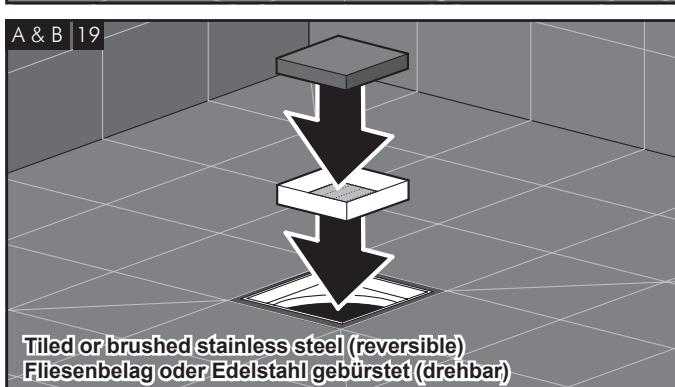
Siphon Reinigung / Siphon Cleaning / Nettoyage du siphon / Sifon čištění / Szifon tisztítása / Czyszczenie syfonu
