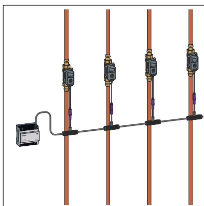
Abb. 5: AquaVip-Netzteil und x AquaVip-Zirkulationsreguliertventile, Spannungsversorgung mit AquaVip-T-Verbindern
