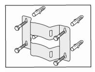
Schrauben mit geringem Abstand zur Wand eindrehen, um Konsole mit vorgesehenen Ausstanzungen einhängen zu können. In der Regel sind 2 Schrauben oben ausreichend.
