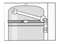
Gefäß komplett mit Konsole und den vorgesehenen Ausstanzungen an den Schraubenköpfen aufhängen und arretieren. Schrauben festziehen.
