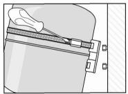
2. Spannband mit Konsole um das Gefäß legen, Band entsprechend Gefäßumfang ablängen und Spannschraube festziehen. Vorsicht: Verletzungsgefahrdurch scharfe Kanten!
