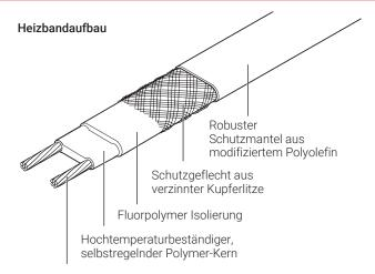
Das selbstregelnde Heizband nVent RAYCHEM FS-C10-2X schützt Rohre vor Frostschäden. Es wird unter der Dämmung direkt auf dem Rohr montiert und ist für den Einsatz im Innenund Außenbereich ausgelegt.
