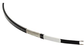
Selbstregelnde nVent RAYCHEM IceStop-Begleitheizungsbander ermöglichen den Frostschutz von Dächern und Dachrinnen, für alle gängigen Materialien von Dachrinnen und Abflussrohren geeignet. Leistung beträgt 36 W/m bei 0 °C in Eiswasser, 18-W/m bei 0-°C in der Luft.
