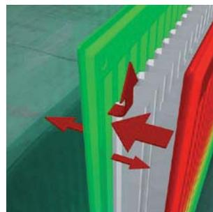
Die Thermografieaufnahme macht deutlich, wie sich technischer Vorsprung in mehr Behaglichkeit und weniger Energieverbrauch umsetzen lässt. Die patentierte serielle Durchströmung der Kerma therm-x2 Flachheizkörper überzeugt in jeder Hinsicht: Dabei wird die Frontplatte zuerst erwärmt. Das genügt meist, um die gewünschte Temperatur zu erzielen. Erst mit steigendem Leistungsbedarf wird auch die hintere Platte erwärmt und trägt mit hoher Konvektionsleistung zur raschen Raumerwärmung bei.
