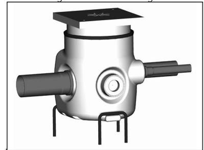
7. Den Behälter fixieren und bündig mit der Oberkante einbetonieren. **ACHTUNG!** Den Abdeckrahmen nicht einbetonieren. Er bleibt bis zu 100 mm in der Höhe frei verstellbar und kann geplante Bodenbeläge ausgleichen (Estrich, Fliesen).
