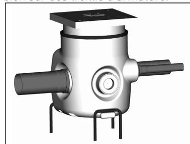
7. Fixer le collecteur et l'enrober dans le béton au même niveau que le bord supérieur. **ATTENTION !** Ne pas enrober le cadre de protection dans le béton. Il permet un réglage en hauteur jusqu'à 100 mm ainsi qu'une égalisation des revêtements de sol prévus (chape, carrelage).
