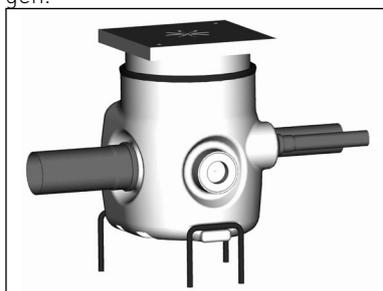
7. Het reservoir fixeren en zorgvuldig met de bovenkant inbetoneren. **ATTENTIE!** Het afdekframe niet inbetoneren. Het blijft tot 100 mm in de hoogte vrij verstelbaar en kan geplande bodembedekkingen compenseren (estrich, tegels).
