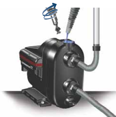
Abb. 9 Auffüllen der Pumpe
