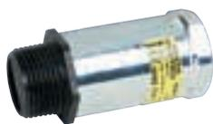
Gasverteiler mit TAE für das alpex-gas System, nur einsetzbar für die Gasinstallation nach dem Hausanschluss, gemäß Techn. Information alpex-gas und TRGI 2008, mit integrierter Eingangs-TAE nach DIN 3586, Ausgänge mit Rp 3/4 IG zur Aufnahme von alpex-gas Gasströmungswächtern mit Gewinde nach DIN EN 10226-1.
