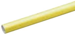
Mehrschichtverbundrohr gelb in Stangen, gemäß VP 632, bestehend aus einer Innenschicht aus vernetztem Polyethylen (PE-Xb), einem längsseitig stumpfverschweißten Aluminiumrohr und einer Außenschicht aus stabilisiertem Polyethylen (PE-HD). Für odoriertes Erdgas H/L sowie Flüssiggas nach DVGW G 260; einsetzbar in der Gasinstallation für Erdgas/Flüssiggas nach dem Hausanschluss innerhalb von Gebäuden gemäß technischer Information alpex-gas und TRGI 2018/TRF.
