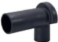
Abdichtung für Wandwinkel aus TPE mit angeformter Dichthülse. Als Wanddurchführung bei Wänden im Nassbereich nach DIN 18534 sowie als Entkopplung vom Mauerwerk und zur Verbesserung des Schallschutzes.
