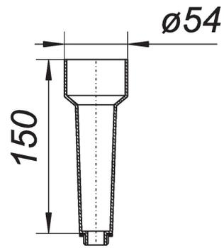
für die Dichtigkeitsprüfung der Ballstau-Kellerabläufe und Stausafe
