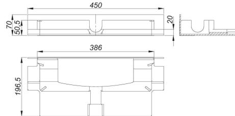
zur Montage mit Ablaufgehäuse DallFlexCeraFlex Plan und Duschrinnen CeraFloor, CeraWall, CeraFrame, Zentrix und CeraNiveau. Bei Einbau gemäß Prüfbericht P-BA 142/2015 (CeraFloor, CeraWall, CeraFrame, Zentrix und CeraNiveau) oder P-BA 144/2015 (CeraWall) geeignet zur Erfüllung der erhöhten Schallschutzanforderungen nach DIN 4109 und VDI 4100.
