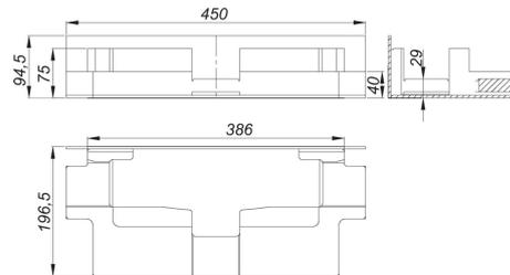
zur Montage mit Ablaufgehäuse DallFlex/CeraFlex und Duschrinnen CeraFloor, CeraWall, CeraFame, Zentrix und CeraNiveau. Bei Einbau gemäß Prüfbericht P-BA 146/2015 (CeraFloor, CeraFrame, Zentrix und CeraNiveau) oder P-BA 148/2015 (CeraWall) geeignet zur Erfüllung der erhöhten Schallschutzanforderungen nach DIN 4109 und VDI 4100.
