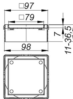
Aufsatz mit Edelstahlrahmen zum Befliesen mit individuellen Bodenbelägen. Passend zu den Ablaufgehäusen DallDrain und dem Aufstockelement DallDrain.
