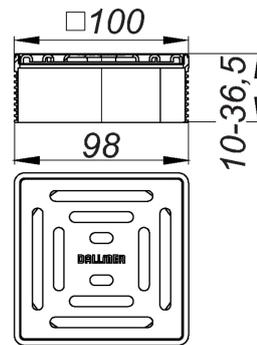
Aufsatz mit Edelstahlrost im Edelstahlrahmen, passend zu den Ablaufgehäusen und dem Aufstockelement DallDrain.
