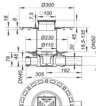
Komplettablauf bestehend aus Bodenablaufgehäuse 42 S, TistoDrain Aufstockelement S 10 und einem stufenlos bis zu 40 mm höhen- und bis zu +/- 5,5 mm seitenverstellbaren Aufsatz.
