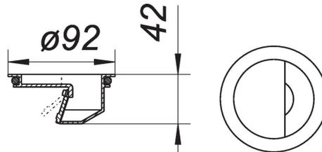
zum Einbau in die Aufsätze und Aufsatzrahmen Serie 10 mit Rahmenmaß 100 x 100 mm und KE 10/KEN 10. Die mechanisch wirkende Sperre verhindert den Austritt von Kanalgasen und Schaum.
