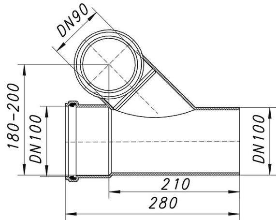
WC-Anschluss DN 90, höhen- und seitenverstellbar
