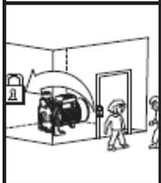
3). Fassen Sie die elektrische Pumpe nicht an, wenn sie in Betrieb ist. Waschen oder schwimmen Sie nicht im Einsatzbereich der Pumpe und halten Sie dort auch keine Tiere, um Unfälle zu vermeiden.
