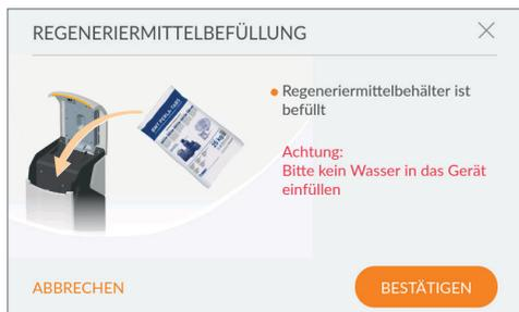
► Füllen Sie Regeneriermittel in den Regeneriermittelbehälter ein. Das Maximalniveau 100 % in der Anzeige des Displays entspricht einer Füllhöhe von ca. 46 cm.
