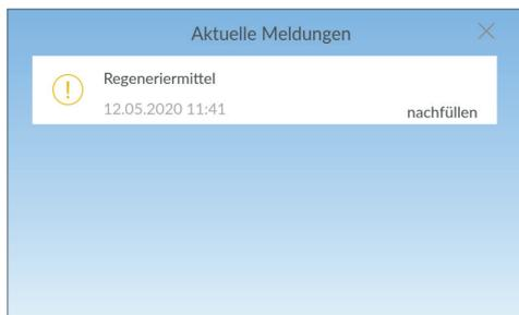
Das Regeneriermittel muss regelmäßig nachgefüllt werden. Das Produkt überwacht mit einem Sensor den Regeneriermittelvorrat und meldet einen Mangel über das Display. Alle handelsüblichen Regeneriermittel nach DIN EN 973 Typ A, (z. B. Perla Tabs) können eingesetzt werden.
