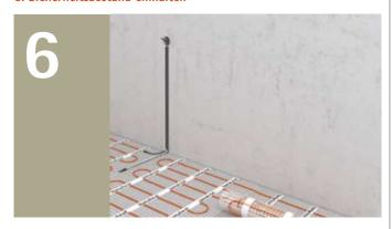
Zwischen den Heizleitern der Umkehrbögen bzw. der einzelnen Bahnen soll ein Sicherheitsabstand von 4–6 cm eingehalten werden, der minimale Abstand von 3 cm darf keinesfalls unterschritten werden.
