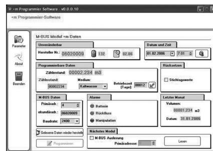
**Achtung:** Unabdingbar für die korrekte Funktion des Moduls ist die Programmierung des tatsächlichen Wasserzählerstandes!
