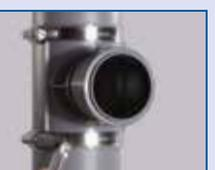
Einfache Installation: Loch bohren, entgraten, Sattel-Abzweig aufsetzen, Schlauchschellen anbringen und leicht andrehen. FERTIG!
