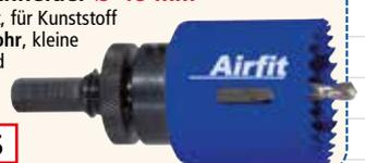
**Zubehör: Kreisschneider Ø 86 mm** HSS-Bimetall, komplett, für Kunststoff u. Metall. Bei Metallrohr, kleine Drehzahl einstellen und Schneidöl zugeben.
