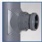
Einfache Installation: Loch bohren (rechtwinklig zur Rohrachse) Ø 57 mm, entgraten, Schraub-Abzweig aufsetzen und anziehen. FERTIG! Brandverhalten: Geprüft nach DIN 4102-B2 EN 13501-1E EN 11925-2.
