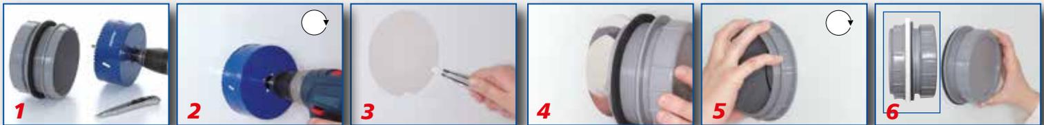
• 2) Loch bohren • 3) Entgraten • 4) Einsetzen • 5) Schraube einsetzen & anziehen • 6) Deckel anziehen **FERTIG!**
